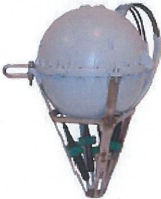
Exemple de flotteur instrumenté pour la mesure in situ de la qualité des eaux (infobit - POINSEL marine)
