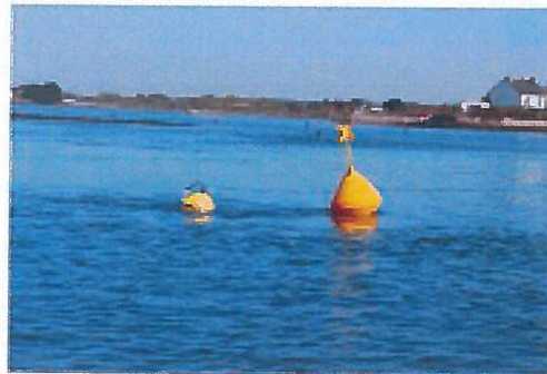
Exemple de flotteur instrumenté pour la mesure in situ de la qualité des eaux (infobit - POINSEL marine)
